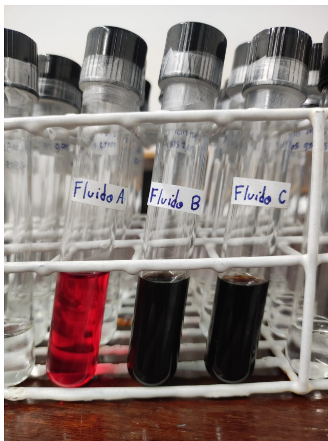
Figura 8.2: Fluidos de transmissão (GM DEXRON VI), submetidos a diferentes condições de serviço. Fluido A – controle. Fluido B - de serviço em uma transmissão automática 6T30. Fluido C - de serviço em uma transmissão automática 6L50.
